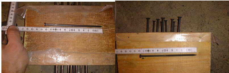
Rys. 1. Zdjęcia próbek z łącznikami przed zalaniem mieszanką betonową.
